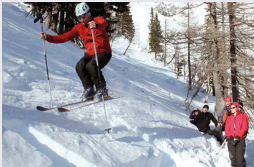
✓ Ukázka praktického provedení testu klouzavého bloku na strmém svahu.
