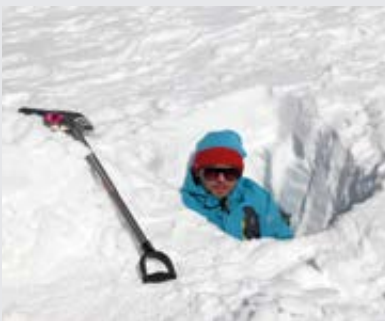
▲ Sněhový profil s rastrem 5 cm (nahore). Výkop pro zjištění sněhového profilu nemusí být velký, stačí jedna osoba (dole).
